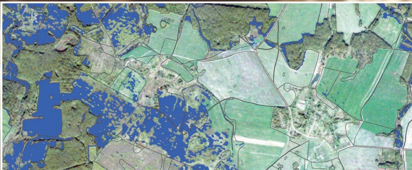
Результат дешифрирования древесно-кустарниковой растительности (обозначена синим цветом) на землях сельскохозяйственного назначения
