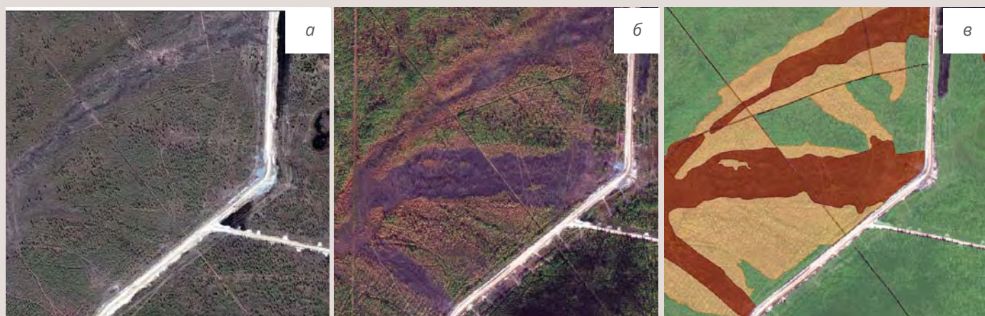
а) снимок QuickBird, 2004 г.; б) снимок GeoEye, 2014 г.; в) картосхема деградации растительного покрова
