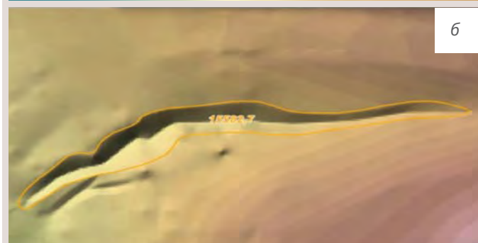
Расчет количественных показателей растущего оврага: а) матрица высот (DEM); б) поверхность TIN
