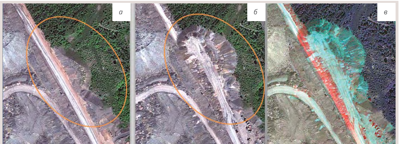
Мониторинг разработки нового карьера: а) WorldView-2, 16.06.2010 г.; б) WorldView-2, 08.07.2010 г.; в) Композит
