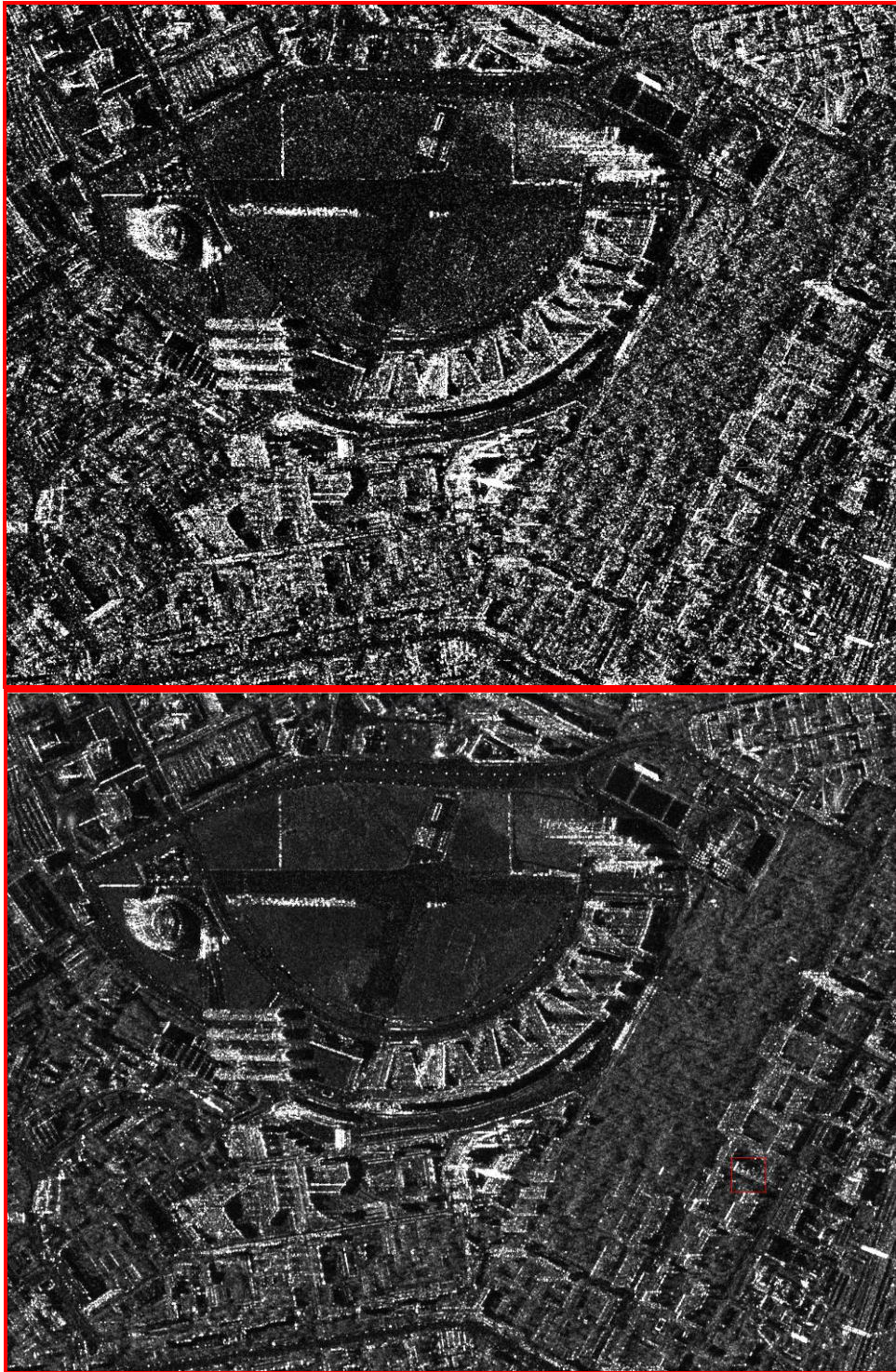
Рис. 9. Исходная (сверху) и фильтрованная мультитременным фильтром (снизу) амплитуда радарного снимка TerraSAR-X (Infoterra GmbH). Используются функции импорта, некогерентного накопления, корегистрации и мультитременной фильтрации (Совзонд, 2010).
