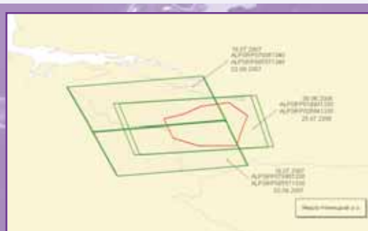
Рис. 1. Схема покрытия района Заполярного месторождения радиолокационными данными ALOS PALSAR
