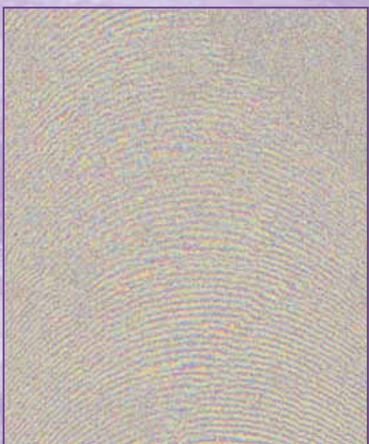
Рис. 3. Интерферограмма, рассчитанная по паре снимков ALOS PALSAR от 09.06.2006 г. и 25.07.2006 г. на район Заполярного месторождения
