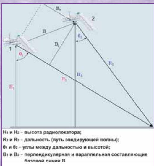
Рис. 2. Пространственное положение радиолокаторов, изображения с которых образуют интерферометрическую пару
