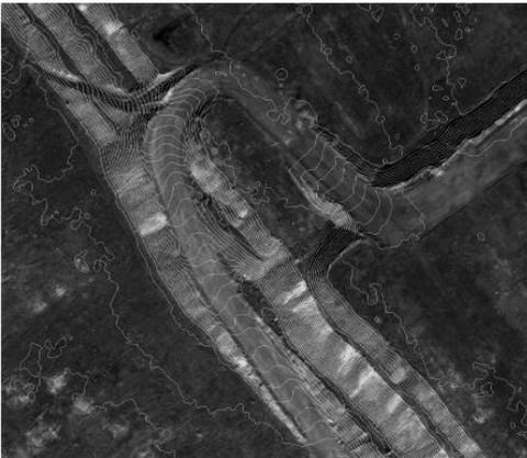
Рис. 2. Составление горизонталей по космическому стереоснимку
