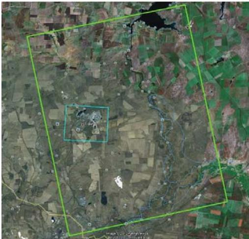
Рис. 1. Схема покрытия территории ОАО «Гайский ГОК» (контур голубого цвета) данными съемок COSMO-SkyMed (зеленый контур). Обработка производилась только на территорию ОАО «Гайский ГОК» (контур голубого цвета). В качестве фоновой подложки — оптический снимок Google Earth.
