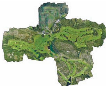
Рис. 3. Полученная мозаика снимков по данным с четырех пролетов БПЛА
