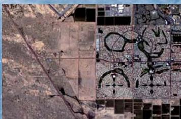
Рис. 4. Ортопротрансформированное изображение RapidEye на Феникс в полном разрешении, скорректированное без опорных точек, с наложенными векторами карт USGS масштаба 1:24 000
