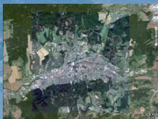
Рис. 6. Ортопротрансформированное изображение RapidEye на Злин в полном разрешении, скорректированное без опорных точек, с наложением Google Earth
