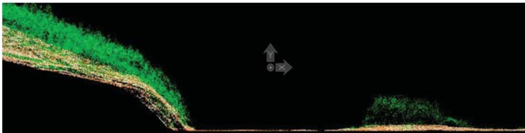
Рис. 2. Пример «пробивания» растительности по данным воздушного лазерного сканирования (переход р. Ангара, съемка в масштабе 1:2000, камера Riegl Q560)
