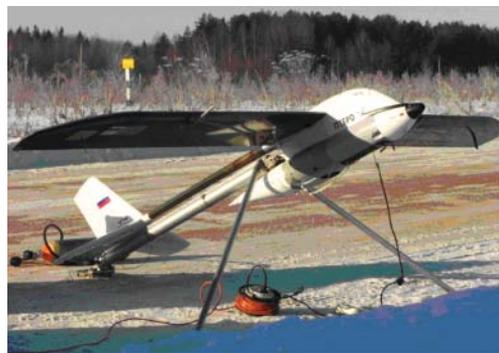
Рис. 3. Образец беспилотного летательного аппарата АФМ-СЕРБЕРС
