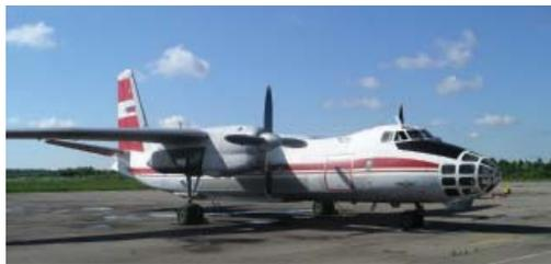
Рис. 1. Аэросъемочный самолет Ан-30ФК
