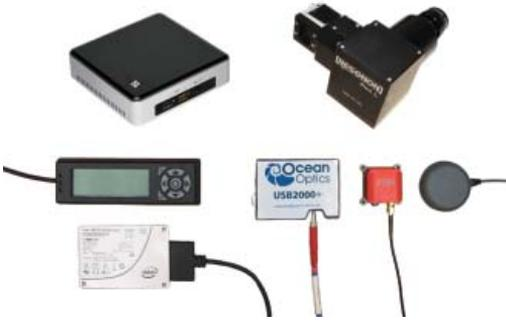
Рис. 5. Комплект оборудования аэросъемочной системы Pika L
