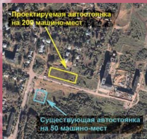
Рис. 11. Пример выбора места для размещения автостоянки открытого типа на ортофотоплане города
