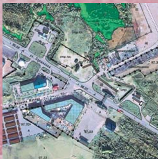
Рис. 9. Фрагмент совмещенного ортоцифры IKONOS и векторного плана
