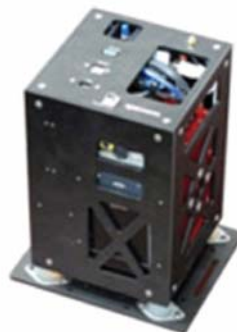
Рис. Аэрозъемочная бортовая гиперспектральная система в антивибрационном футляре
