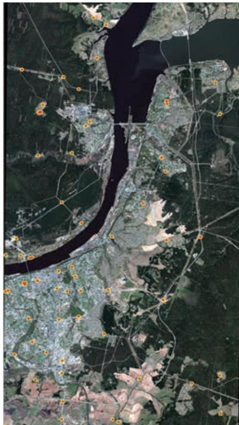
Рис. 2. Расположение опознаков на ортоснимке 425610
