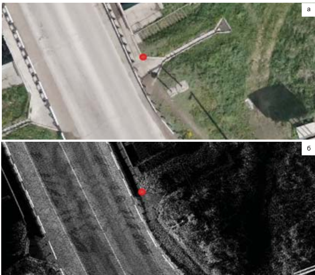
Рис. 3. Размещение точек для оценки точности планового положения ортофотоплана: а) ортофотоплан; б) данные МЛС
