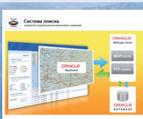
Рис. 1. Схематическое представление системы поиска покрытия территории космическими снимками
