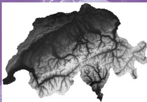
Рис. 5. ЦМР, построенная специалистами SARMAP (разработчиками SARscape) по данным тандемной интерферометрической съемки со спутников ERS-1 и ERS-2 в конце 1990-х гг.
