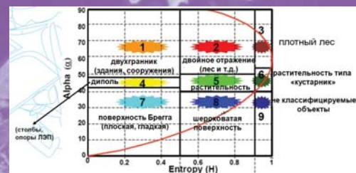
Рис. 2. Классы объектов, различающиеся по физическому типу отражения, выделяемые SARscape
