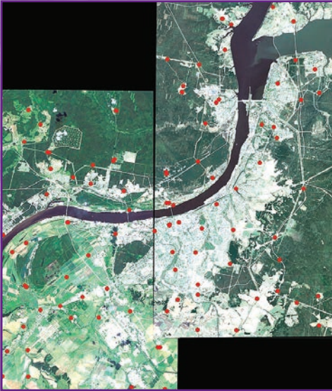
Рис. 3. Схема расположения опознаков
