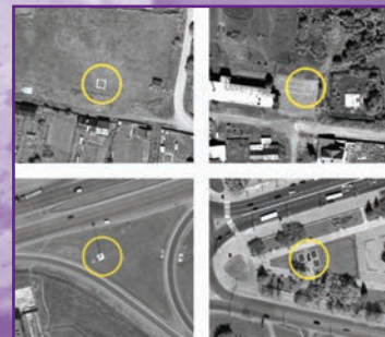
Рис. 2. Примеры выбора наземных опорных точек (опознаков)
