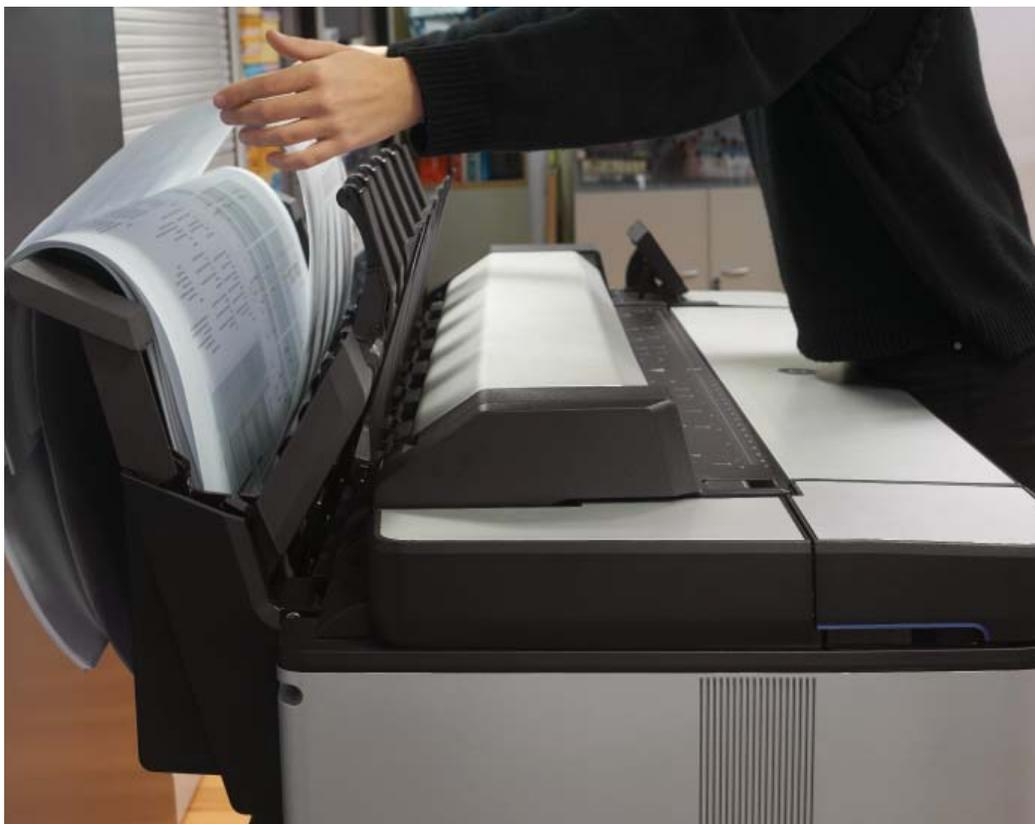
Рис. 2. МФУ HP DesignJet T3500 оснащен приемным накопительным лотком, который аккуратно складывает до 100 листов формата А0
