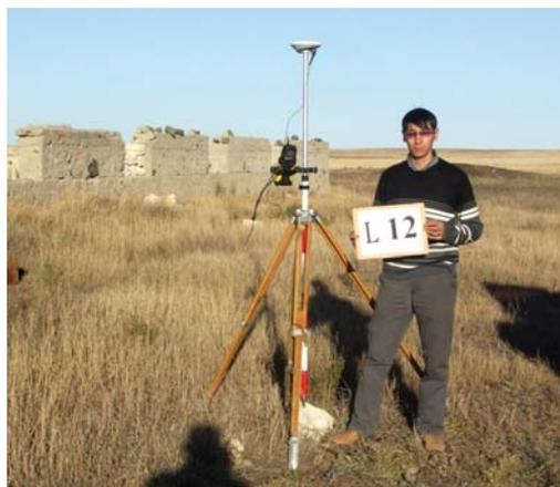
Рис. 3. Идентификация и измерение GPC на местности
