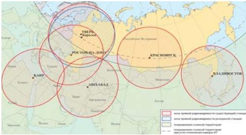
Рис. 6. Распределенная сеть наземных станций ЗАО НПК «БАРЛ»
