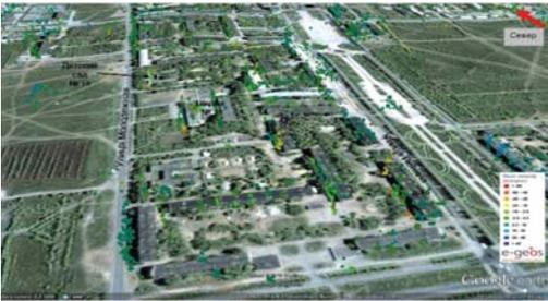
Рис. 7. Трехмерное отображение постоянных рассеивателей, выявленных между улицами Ленина и Молодежной города Гая, показывающее, что многочисленными рассеивателями покрыты практически каждый пролет многоквартирных жилых домов. Фоновая подложка — оптический снимок из Google Earth
