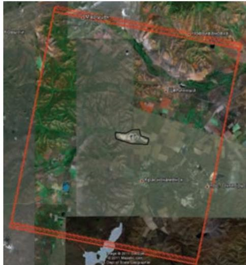
Рис. 1. Схема покрытия территории угольного разреза Уртуйский (черный контур) данными радарных съемок COSMO-SkyMed (красные контуры)
