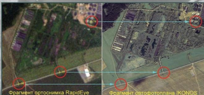
Исследование точности ОРТО50 (определение геодезических координат измеряемых точек на ортоснимке RapidEye по ортофотоплану IKONOS)
